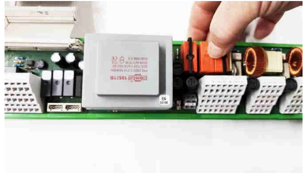
Das eingesetzte Relais vorsichtig festdrücken
